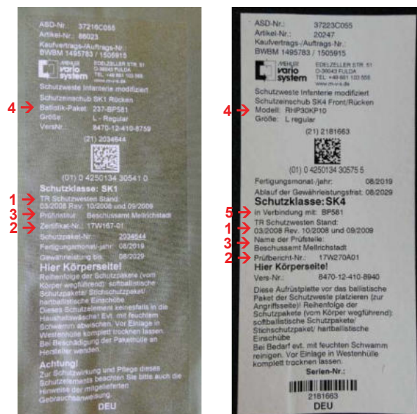
Abbildung 1: Zertifizierungsangaben auf einem weich- und hartballistischen Schutzelement
